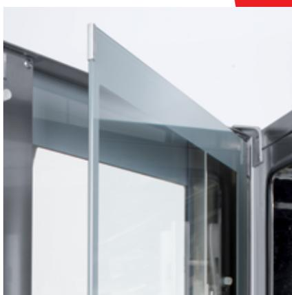
Puerta de cierre con doble cristal templado termoreflexor, a intersticio de aire para reducir la irradiación de calor hacia el operario y obtener mayor eficiencia.
